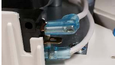
Fig. 4: - Contacts de flotteur de haut niveau en position N.F.
