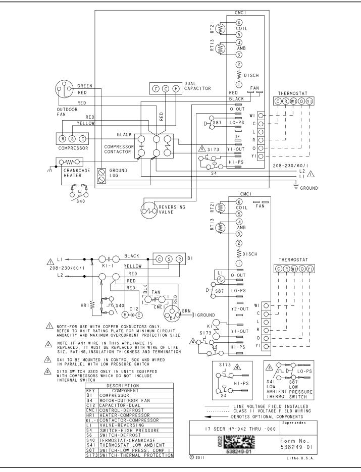
Figure 8. Wiring Diagram 042 - 060 Models
