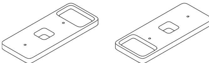
В зависимост от варианта за монтаж се променя референтната точка за сифона (и стенната арматура). Това е изходната точка за измерване на точките на закрепване. В техническия чертеж размерите са дадени за рафт, монтиран отдясно.
