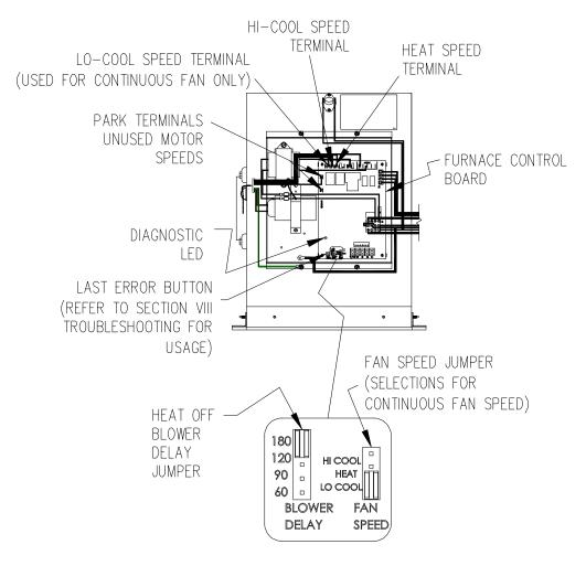
FACTORY BLOWER SPEED WIRING & JUMPER SETTINGS
