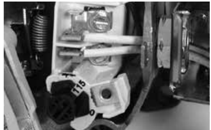
Figura 9 - Tensión configurada para 115 V, tipo cuadrante.
