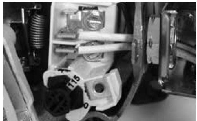
Figure 9 - Tension réglée à 115 V sur sélecteur à cadran
