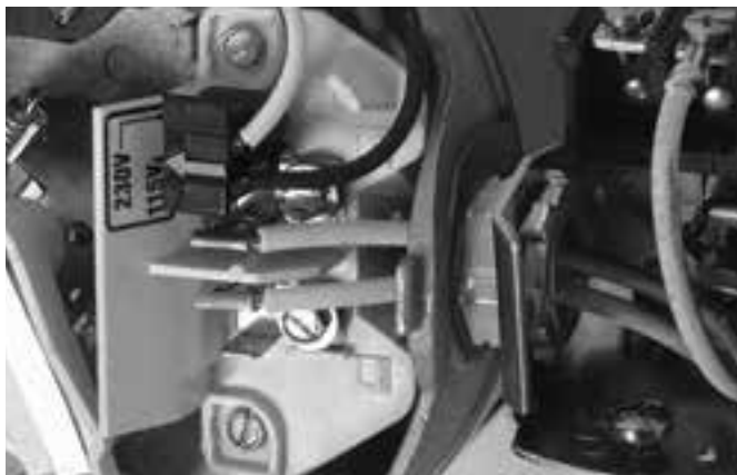
Figura 7 - Tensión configurada para 115 V, tipo ficha.
