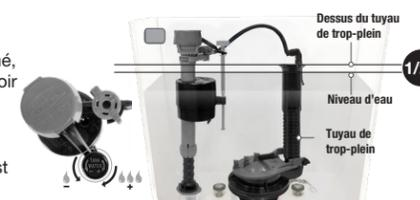
\*Un serrage excessif peut endommager le robinet de remplissage ou l'écrou d'accouplement et provoquer une inondation. S'assurer que la cuvette de niveau ne touche pas aux parois, au levier du réservoir ou au robinet de chasse.
