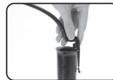
**B: ATTACHER LA CHAÎNE DU CLAPET.**
