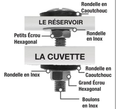
**B: FIXER LE RÉSERVOIR SUR LA CUVETTE.**
